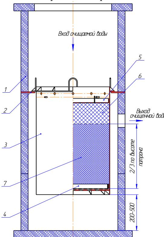
Работа фильтрующего патрона основана на использовании механического и физико-химического методов очистки сточных вод.
