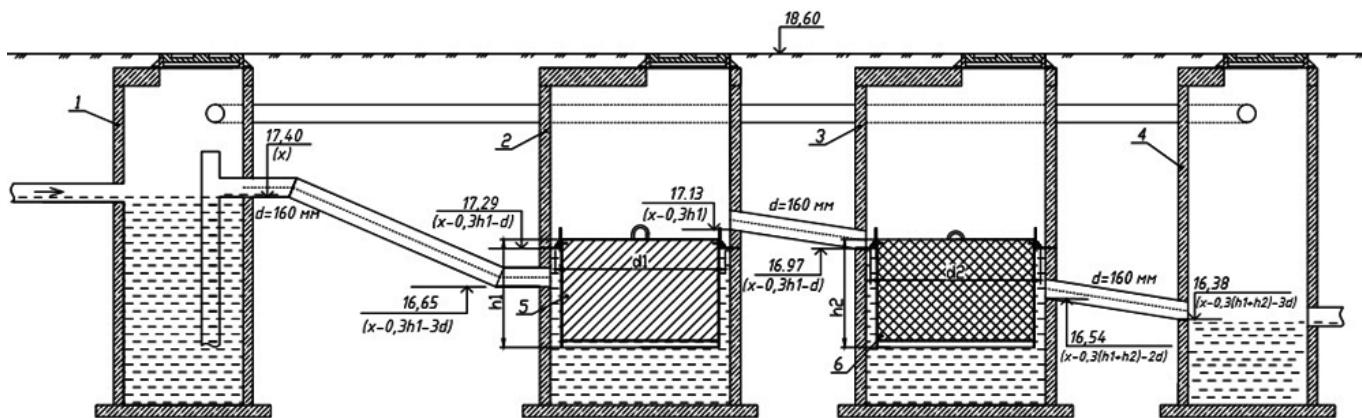
Рис 2. СФП с байпасом между 1 и 4 колодцами (и дополнительной установкой двух поворотных колодцев) и установкой в колодце №1 переливного лотка и нефте- и сорозадерживающего устройства.
